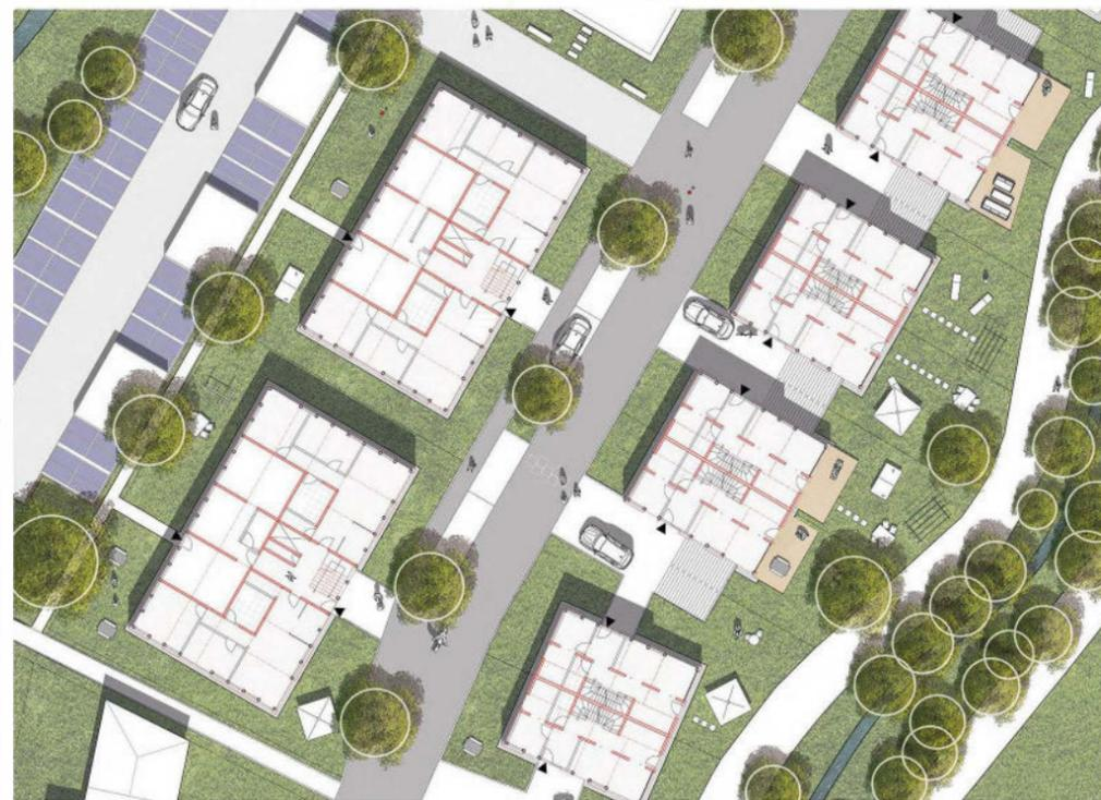
Erdgeschoss Grundriss M 1:150
